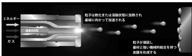
図2b 溶射皮膜形成の原理
